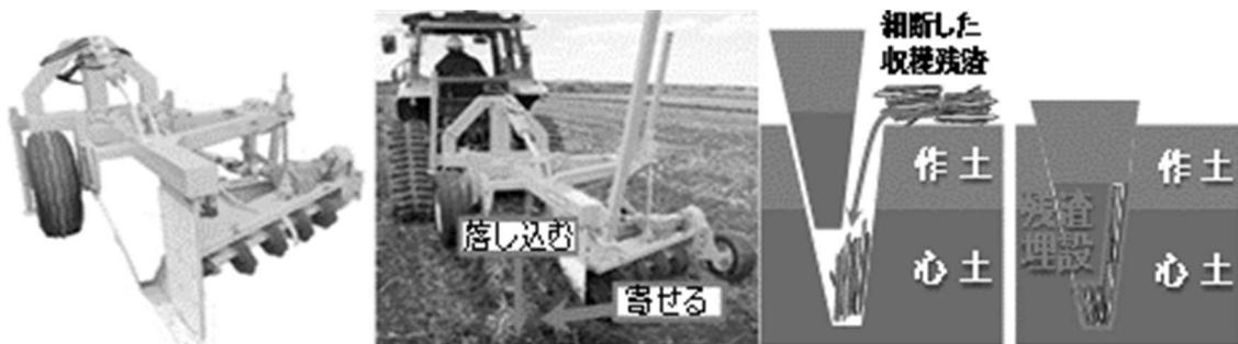
図1 カットソイラーの機構図(株式会社 北海コーキ製品カタログ参照)
