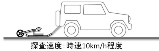
図-3 車両による探査システムのけん引イメージ
