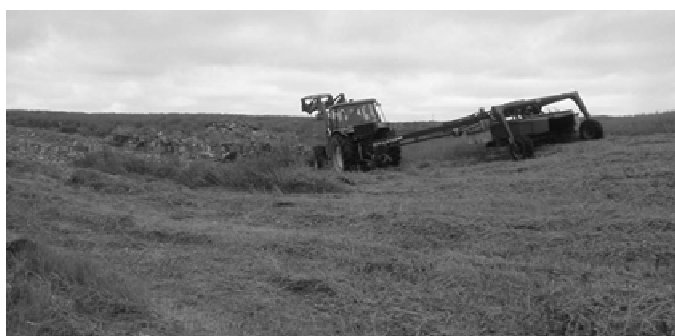
図-1-2 部分的な急傾斜により作業性悪化 (写真提供：北大野口教授)
