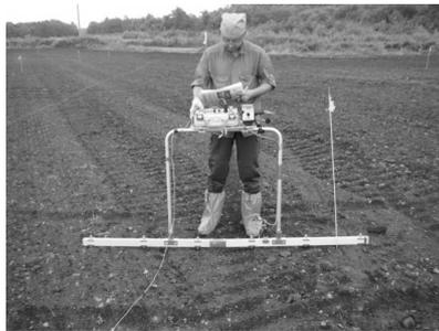
写真-4 移動式電気探査
