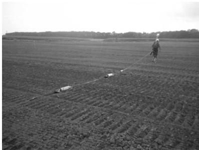
写真-3 けん引式電気探査
