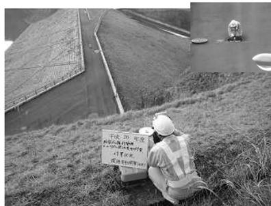
写真－３ 変形計測
