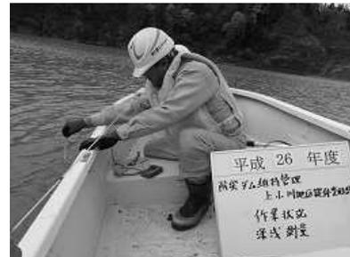
写真－４ 堆砂量計測
