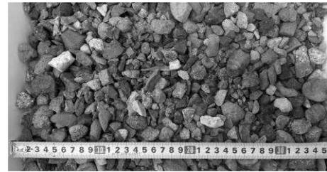
写真-1 疎水材 (粒径 5~25mm)
