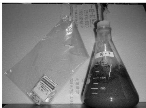
図-1 室内実験用発酵槽
