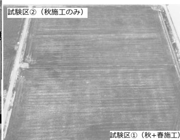
写真 13. 地下かんがい後の乾燥過程 (滝川 H29)
