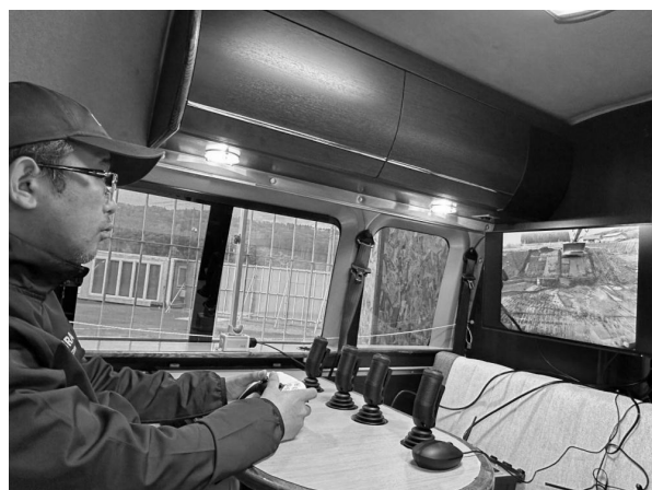
【写真2】遠隔施工に対応した「遠隔施工支援車両」の外観と車両内部
