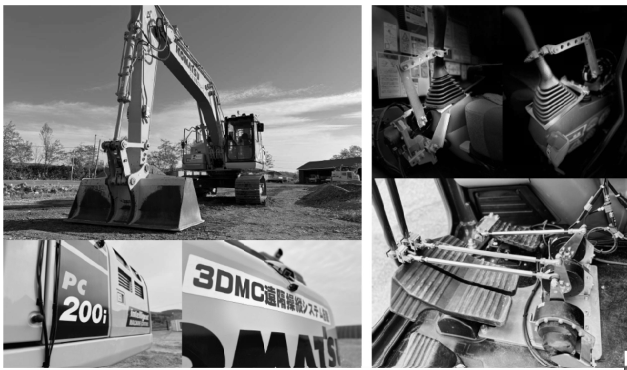
【写真1】 3DMCバックハウの外観と運転席内部の遠隔操作システム搭載状況
